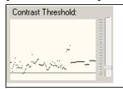
Le paramétrage du seuil de contraste se compose de deux parties : d'un moniteur graphique pour les contrastes dans l'image et du régleur.
