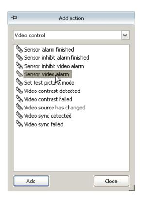
Sous Start by [Démarrage à], nous voyons maintenant une mention alarme de détecteur et nous pouvons, dans la zone de réglage, décider du type d'alarme de détecteur qui doit être attribué. Sans licence, il ne reste que le type de détecteur DA.
