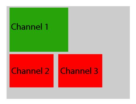
Un double-clic de la souris sur le visualiseur lié du premier canal (indiqué ici en vert) conduit à la mise en ligne de modèle-type suivante : L'image du canal 2 est mise en ligne sur le grand visualiseur, le canal 1 se décale sur le visualiseur ancien du canal 2 - en un mot : il s'effectue un échange entre les visualiseurs.
